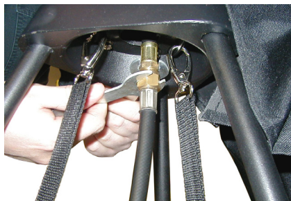
Figura 11 - Cómo fijar la manguera del regulador a la línea de combustible del quemador
